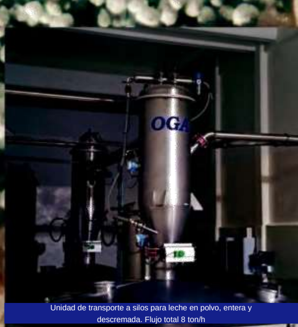
Línea de secado de leche en polvo, transporte en fase Ultradensa por vacío
