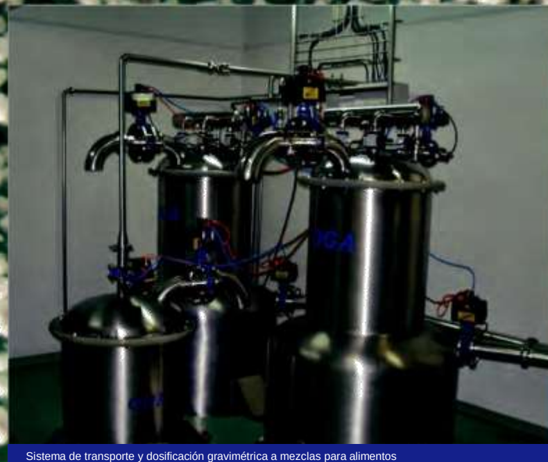
Sistema de transporte y dosificación gravimétrica a mezclas para alimentos
