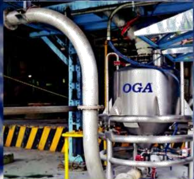
Sistema fase densa a bascula para carga a granel carro tolva. Flujo 50 Ton/h
